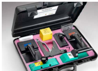
1. Náradie Climaver na výrobu priameho vzduchovodu a tvaroviek.
