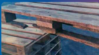
Zle upevnená doska a uvoľnený klinec
