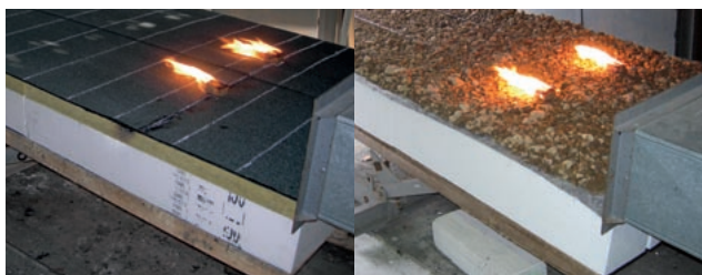
Příklady zkoušek skladeb vhodných pro požárně nebezpečné prostory s klasifikací B_{ROOF}(t3) .
