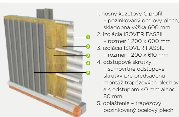
Obr.3.B.3 Schéma systémového zateplenia ISOVER CLADISOL
