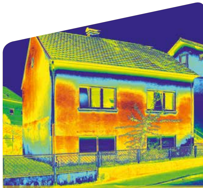
Obr. 2.A.1 Príklad termovíznej snímky rodinného domu pred zateplením
