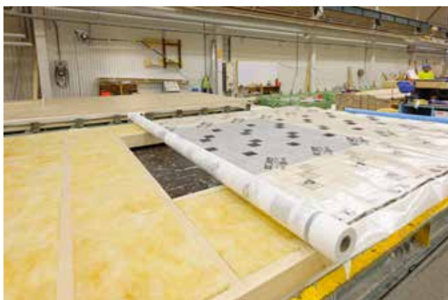
Obr.3.C.2 Príklad prefabrikovanej stĺpikovej konštrukcie drevodomu
