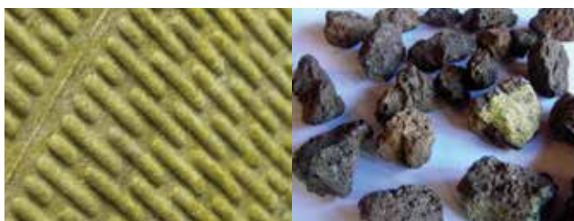
Obr. 6.B.1 Tepelná izolácia vyrobená z kamennej vlny. Hornina, z ktorej sa vyrába
