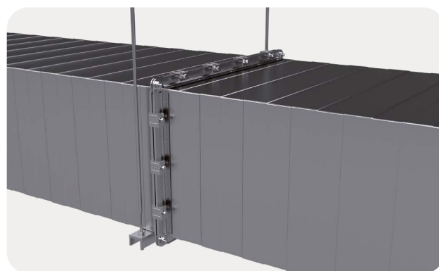
Obr. 40 Závěsné zařízení se umísťuje do blízkosti přírub (maximální vzdálenost od příruby je 200 mm).
