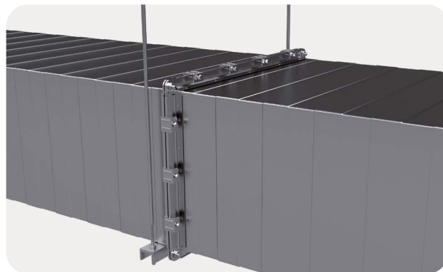
Obr. 64 Závěsné zařízení se umísťuje do blízkosti přírub (maximální vzdálenost od příruby je 200 mm).
