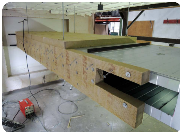
Obr. 66 Horní deska se nekotví přivařovacími trny, pouze se kotví požárními vruty Fire Screw k boční desce.
