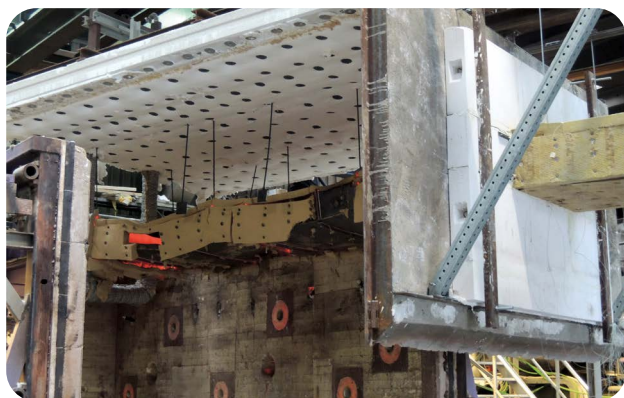
Obr. 8 Vzorek vzduchotechnického potrubí typu B, chráněného protipožárním systémem ULTIMATE Protect, bezprostředně po skončení 120minutového testu.
