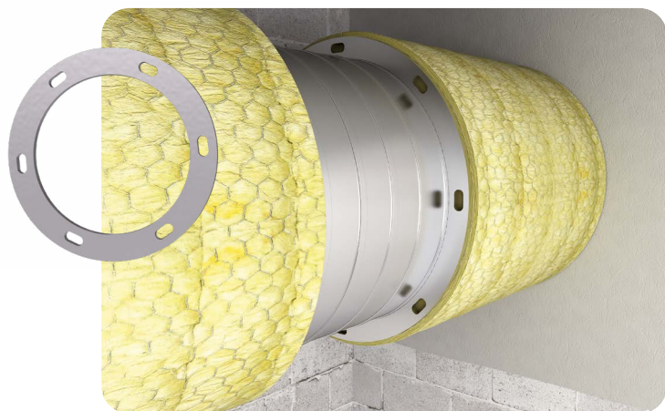
Obr. 54 V případě požadavku požární odolnosti EI 120 potrubí vyžaduje vnější zesílení pomocí kruhových obručí 40 × 5 mm umístěných mezi závěsy po vzdálenostech 1 200 mm (šířka rohože je 600 mm).
