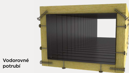
Obr. 41 U vodorovného potrubí horní deska překrývá boční desky, které překrývají spodní desku.
