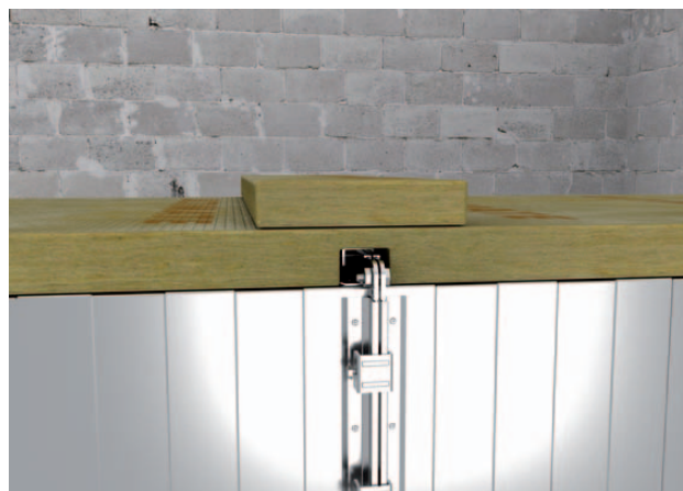
Obr. 47 Je-li použita izolační deska o tloušťce \leq 40 mm, nad přírubu se umístí pásek druhé vrstvy izolace o min. tloušťce 30 mm a šířce 150 mm
