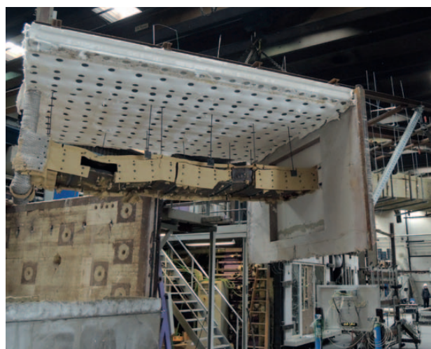
Obr. 17 Pohled na potrubí typu C po 120 minutách působení normového požáru
