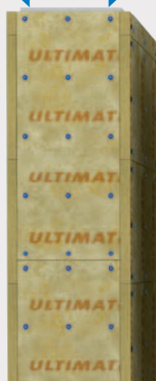
Obr. 76 Rozmístění trnů a vrutů u svislého potrubí
