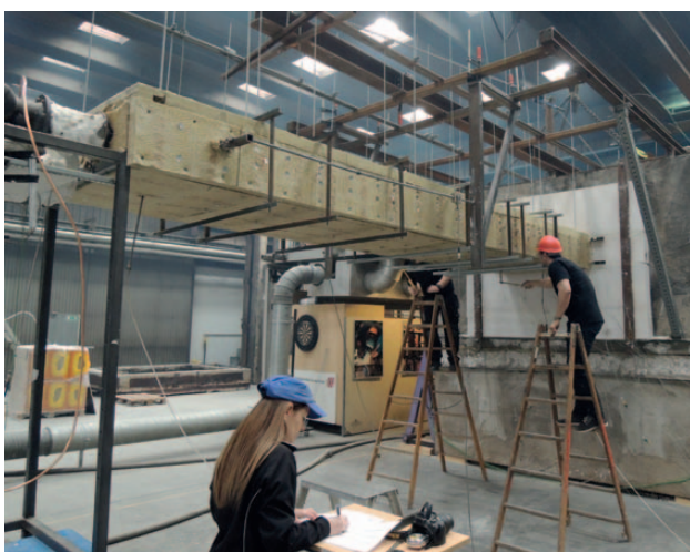
Obr. 16 Měření deformace potrubí typu C při zkoušce ve zkušebně
