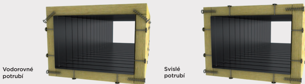
Obr. 42 Horní deska překrývá boční desky, které překrývají spodní desku
