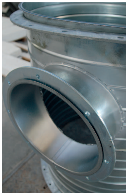
Obr. 31 Pohled na spiro potrubí spojované přírubami před montáží
