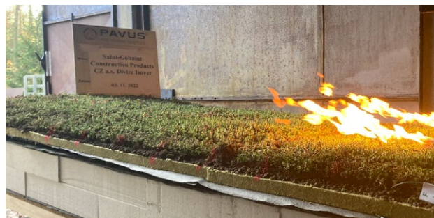
Požární zkouška ploché střechy
