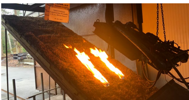
Průběh požární zkoušky šikmé střechy
